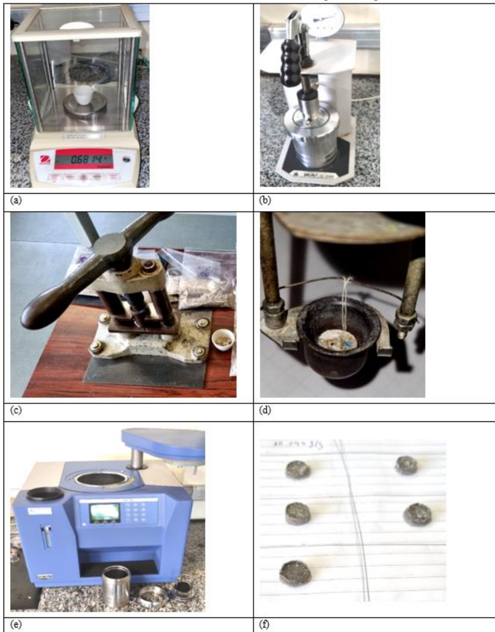
Figura 5. Determinação do PCS: (a) Balança analítica; (b) recipiente de decomposição ou vaso de pressão; (c) prensa da amostra; (d) cadinho metálico; (e) Calorímetro de combustão; (f) amostra na forma de pastilhas prensadas.
