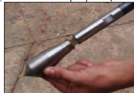
Figura 2. Ponta do DPL para penetração no solo.
