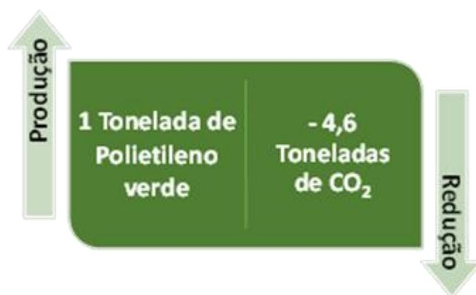
**Fig. 10. Redução de emissões de CO<sub>2</sub> por tonelada de PE verde produzido [14].**
