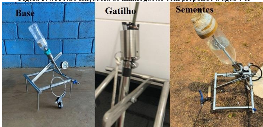
Figura 3.4. A base lançadora de minifoguetes com propulsão à água e ar
