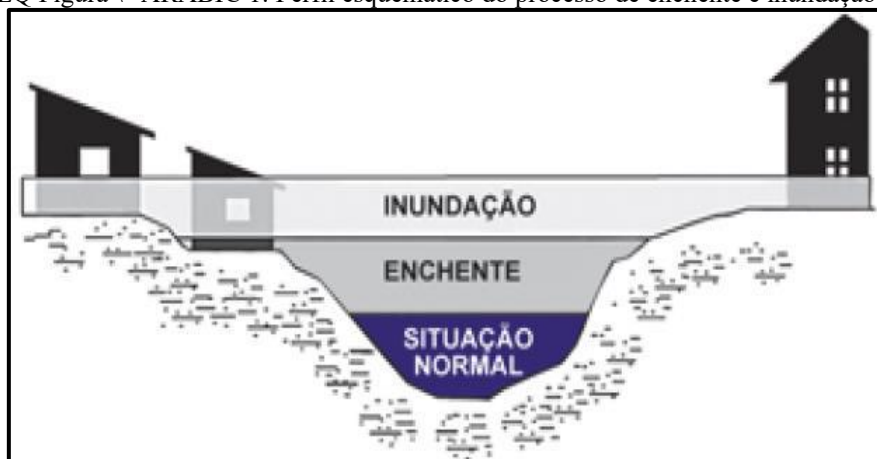
Figura: SEQ Figura \* ARABIC 1: Perfil esquemático do processo de enchente e inundação - Adaptada
