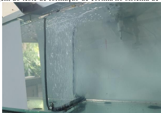
Figura 2 – Imagem do teste de formação de cortina no sistema de cortina de bolhas.
