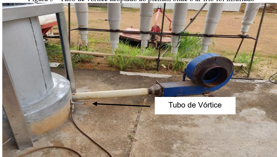
Figura 5 - Tubo de vórtice acoplado ao plênum onde o ar frio foi insuflado
