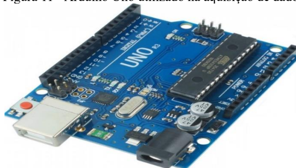
Figura 11 - Arduino Uno utilizado na aquisição de dados
