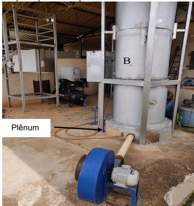
Figura 1 - Silo protótipo utilizado para avaliar o sistema de resfriamento artificial
