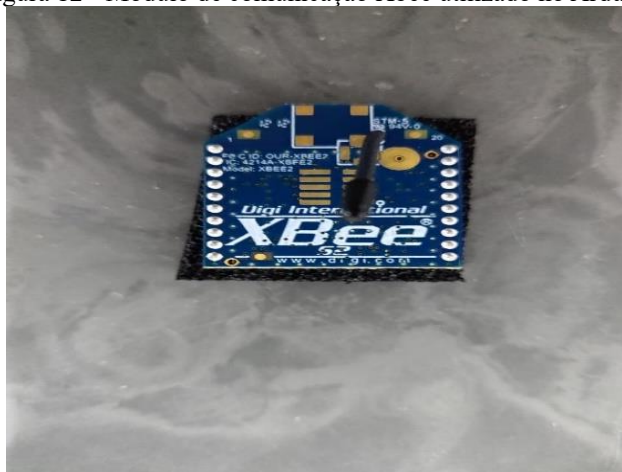
Figura 12 - Módulo de comunicação Xbee utilizado no Arduino
