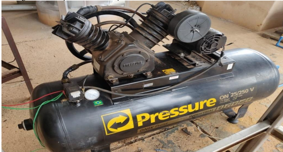
Figura 6 - Compressor utilizado para fornecer o ar comprimido ao tubo de vórtice
