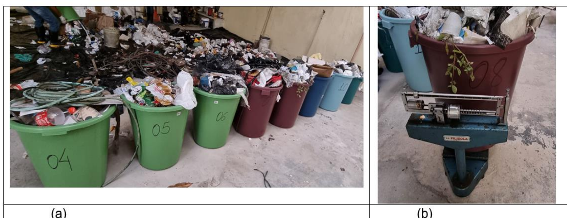
Figura 5. Pesagem do volume de 1m 3 de RSU: (a) Medição do volume; (b) Medição da massa.
