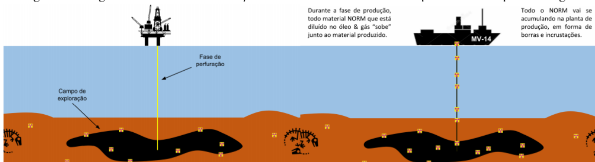
Figura 5 - Imagem descreve a transformação de NORM em TENORM nas plataformas de petróleo e gás.
