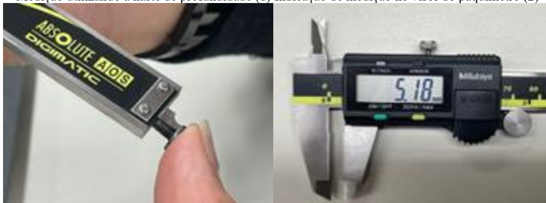
Figura 3 – Medição do parafuso Medição utilizando a haste de profundidade (1) Indicação de medição no visor do paquímetro (2)
