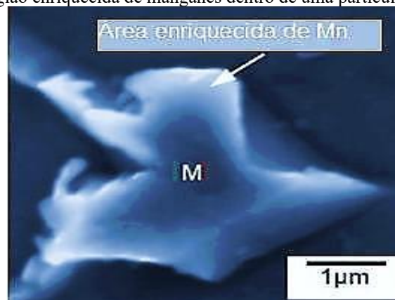
Figura 4: Região enriquecida de manganês dentro de uma partícula de martensita
