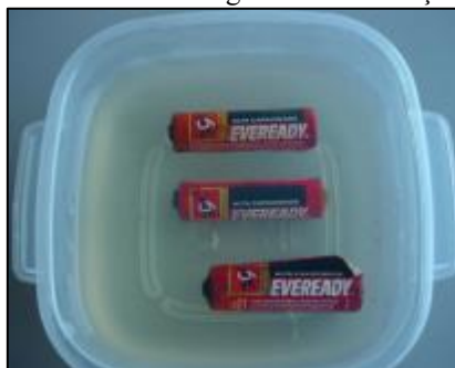
Figura 7 – Pilhas usadas imersas em gelatina com adição de 3,5 % de NaCl
