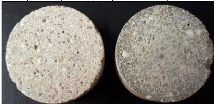
Figura 16 – Aspectos da superfície corpos de prova de concreto após 600 horas de ensaio
