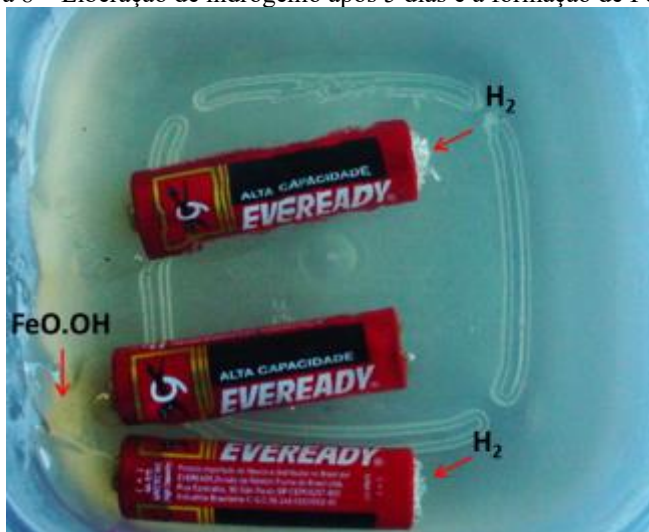
Figura 8 – Liberação de hidrogênio após 5 dias e a formação de FeO.OH
