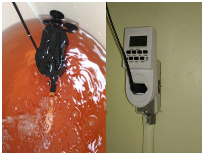
Figura 5 – Esquema do temporizador e bomba para abastecimento nutrientes na horta hidropônica. (Fonte: os autores)
