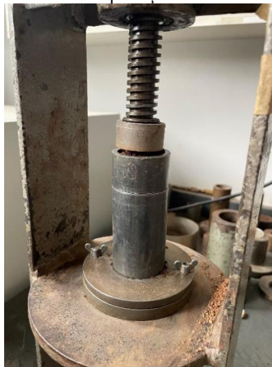
Figura 2.9 – Processo de compactação manual dos corpos de prova.
