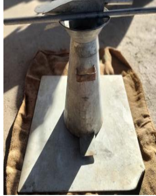
Figure 10– Cone para Slump Test.
