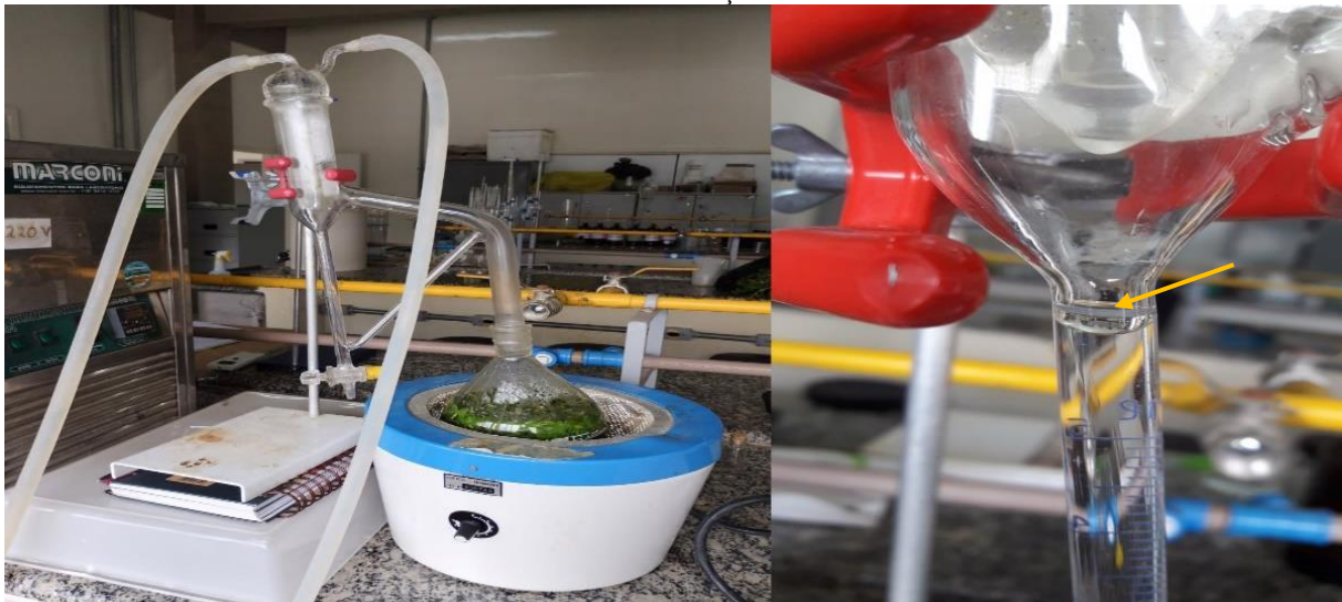
FIGURA 3 – PROCESSO DE DESTILAÇÃO POR ARRASTE A VAPOR
