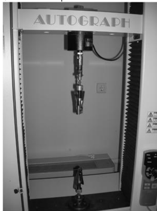
Figura 6. Dinamômetro operando um teste de tensão de ruptura.
