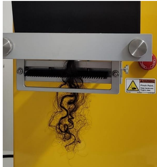
Figura 8. Texturômetro CT3 Ametek-Brookfield durante teste de compressão.
