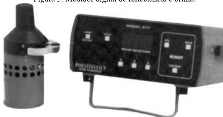
Figura 5. Medidor digital de refletância e brilho.
