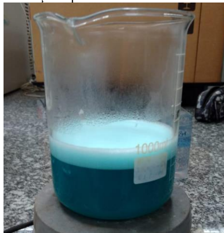
Figura 4 - Solução aquecida de Nitrato de cobre e gelatina.
