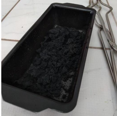
Figura 5 - Resultado da pré-queima do cobre.
