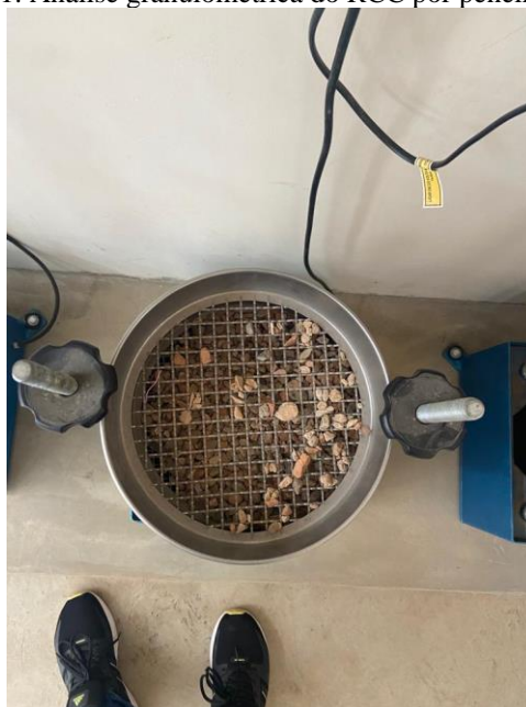
Figura 1. Análise granulométrica do RCC por peneiramento.
