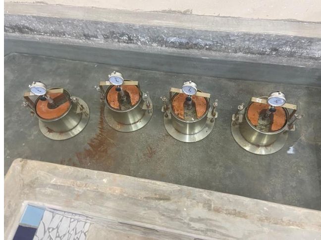
Figura 5. Corpos de prova submersos em tanque com água.
