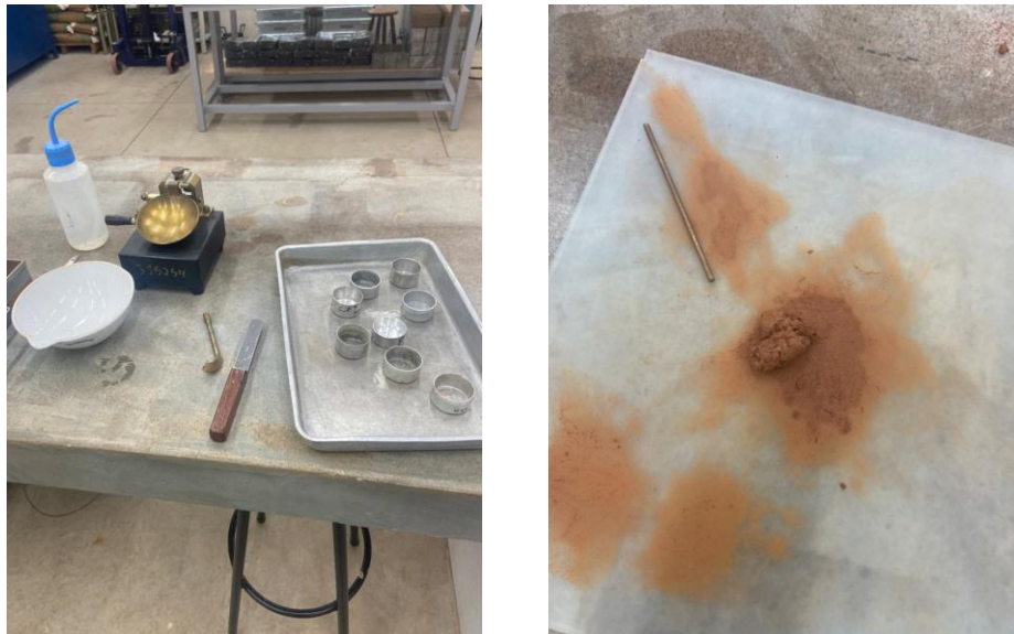
Figura 2. Equipamentos utilizados no ensaio dos limites de Atterberg (à esquerda) e gabarito e amostra de solo usada (à direita).
