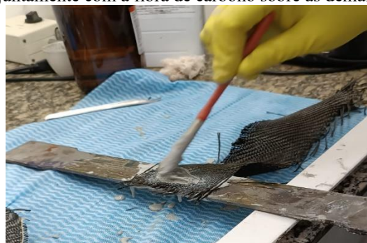
Figura 7- Aplicação do adesivo juntamente com a fibra de carbono sobre as demais camadas. Fonte: O Autor, 2023.
