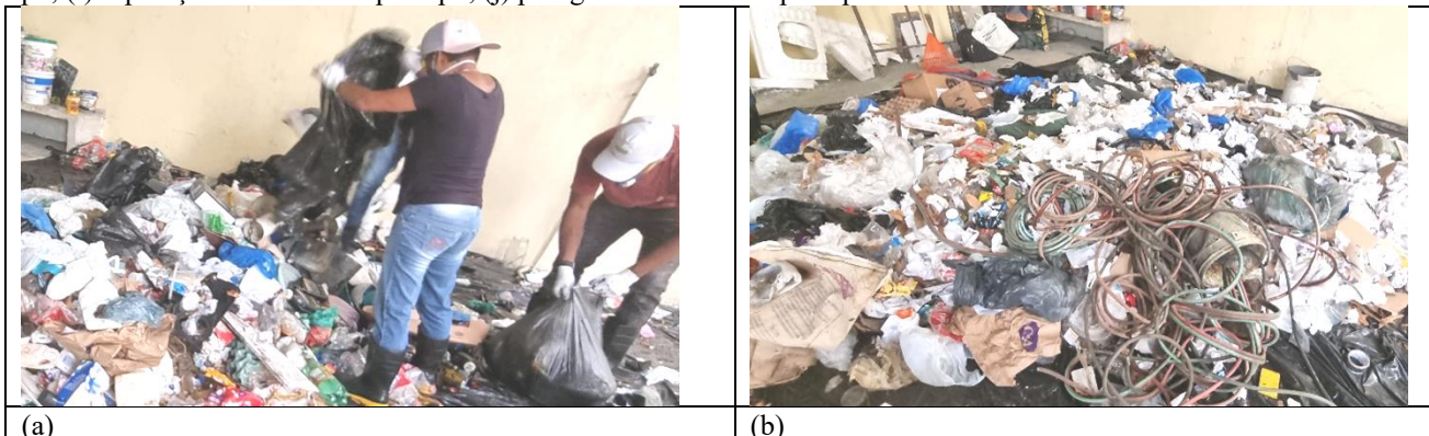
Figura 4. Gravimetria: (a) Retirada dos resíduos dos sacos plásticos; (b) mistura dos resíduos; (c) quarteamento; (d) separação de 1m 3 de resíduos; (e) e (f) pesagem dos resíduos misturados; (g) e (h) pesagem dos resíduos separados por tipo; (i) separação dos resíduos por tipo; (j) pesagem dos resíduos por tipo.
