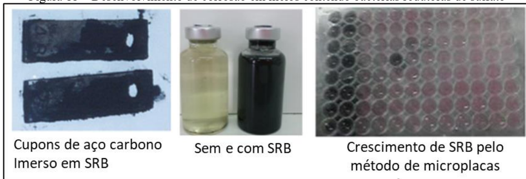
Figura 11 – Desenvolvimento de corrosão em meios contendo bactérias redutoras de sulfato
