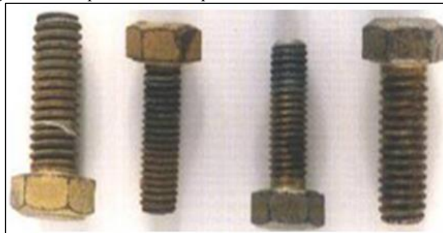
Figura 7 - Ataque de H 2 S em parafusos cadmiados de 150 a 200°C
