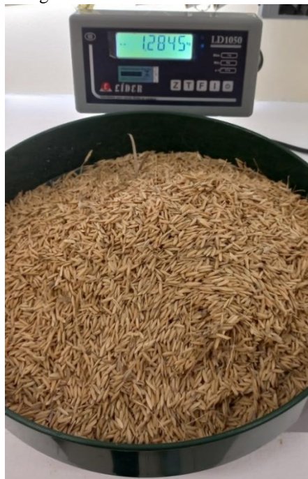
Figura 6 - Pesagem de toda a amostra debulhada manualmente
