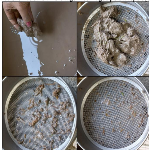
Figura 10 - Solo sendo submetido a uma lavagem com água para a separação dos grãos de arroz
