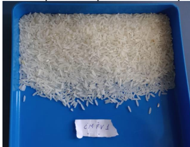
Figura 8 - Grãos inteiros após realizado o percentual de inteiros e quebrados do grão
