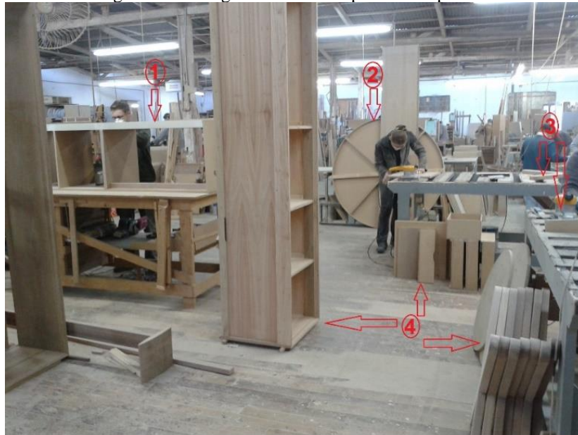
1- Bancada de Montagem 2- Gabarito 3- Bancadas de Lixa 4- Estoques em processo
