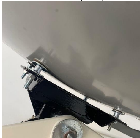
Figura 16 – Estrutura de fixação da parabólica offset.
