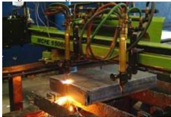
Figura 11. Pantógrafo Oxicorte MPCE – 1500.
