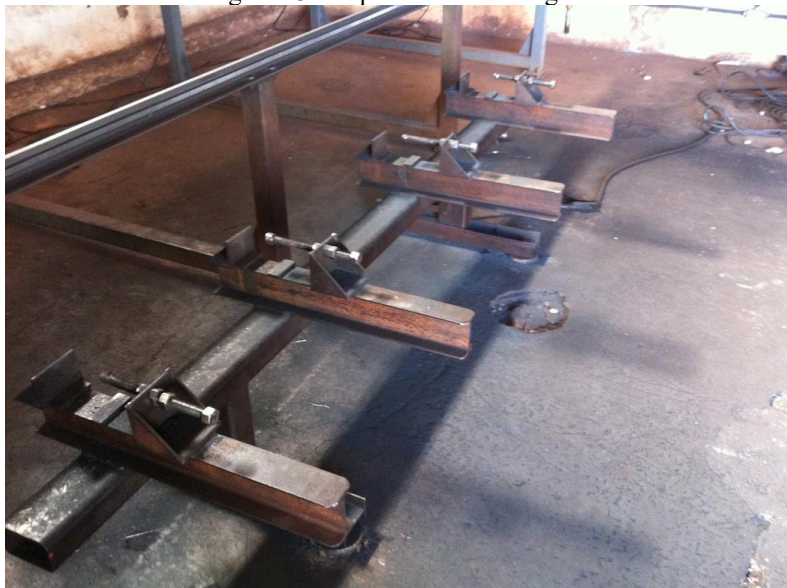
Figura 13. Dispositivo de Soldagem.
