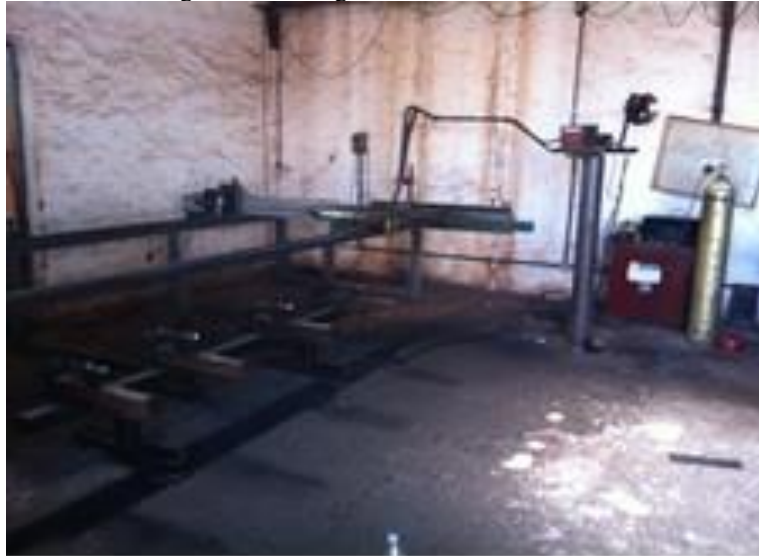
Figura 14. Pantógrafo oxicorte modificado.
