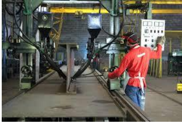
Figura 10. Máquina de solda tipo Arco submerso. Fonte: Indústria e Comércio de Máquinas Agrícolas Mantovani, 2018.
