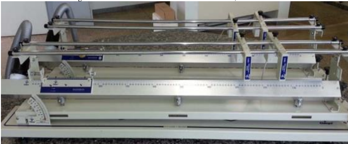
Figura 2: Trilhos de ar com sensores fotoelétricos, vista lateral.
