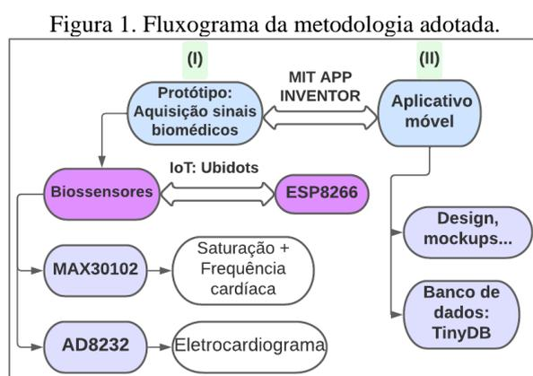
Após conexão dos sensores com NodeMCU ESP8266, a programação para funcionamento dos sensores e classificação dos valores lidos foi realizada no IDE do Arduino. Para aplicabilidade IoT foi utilizado o serviço *Ubidots*, plataforma que vincula *software* e *hardware* para monitoramento, e está relacionada com automatização de sistemas. A autenticação de dados foi realizada através de um *token* disponibilizado no site e inserido na programação juntamente com dados da rede Wi-Fi utilizada. Os
