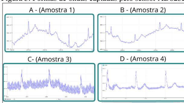
Uma das dificuldades encontradas na elaboração do protótipo foi a questão da conectividade dos sensores NodeMCU ESP8266 com Wi-Fi, sendo necessários testes empíricos e consecutivos, adição de novas bibliotecas na IDE do Arduino e constante reformulação da programação. A forma de onda captada pelo sensor AD8232 pode ser monitorada em qualquer lugar, pelo próprio usuário ou médico, usando um computador ou *smartphones* como apresentado na figura 6.
