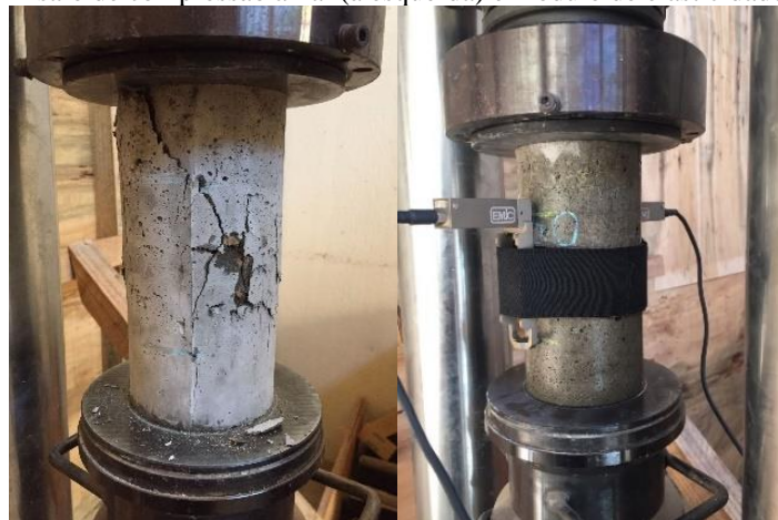
Figura 7 - Ensaio de compressão axial (à esquerda) e módulo de elasticidade (à direita).
