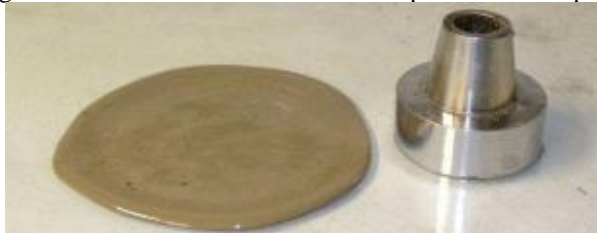
Figura 3 - Ensaio de mini abatimento: espalhamento da pasta.
