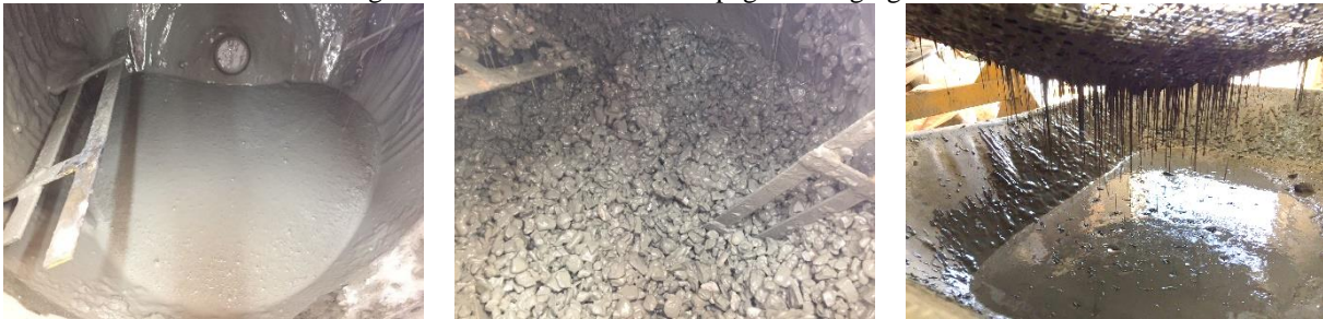
Figura 4 – Procedimentos de dopagem do agregado de RCC.
