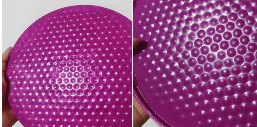
Figura 8: Resultado de amostra de PLA preparada com fôrma para moldagem com superfície inferior removível.
