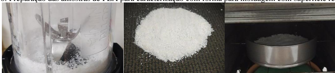
Figura 6: Preparação das amostras de PLA para caracterização com fôrma para moldagem com superfície removível.
