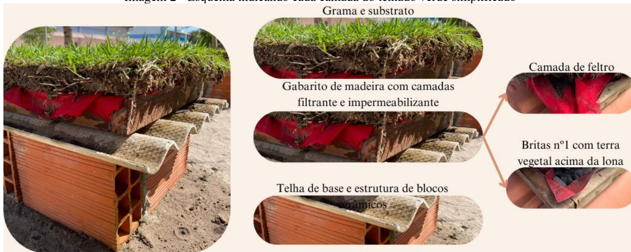
Imagem 2 - Esquema indicando cada camada do telhado verde simplificado
