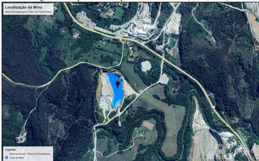
O plano de fechamento foi realizado na cava de uma mina de extração de calcário identificada conforme ilustrado na FIGURA 8, que teve suas atividades paralisadas no ano de 2014 (em torno de 10 anos) devido a inviabilidade econômica para o prosseguimento do processo de extração da rocha calcária por motivos operacionais (aprofundamento da mina, necessidade de aumento na área de supressão, entre outros fatores).
