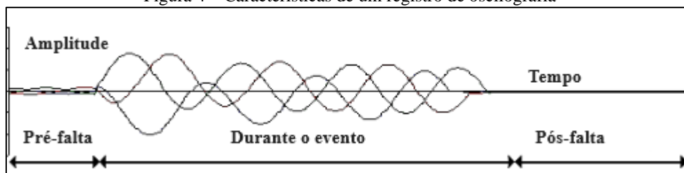
Figura 4 – Características de um registro de oscilografia
