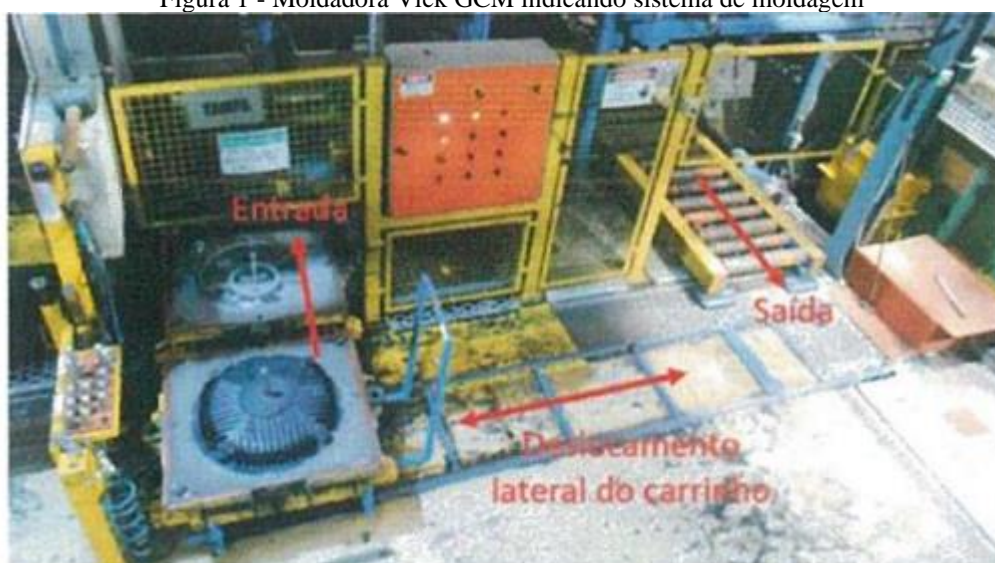
Figura 1 - Moldadora Vick GCM indicando sistema de moldagem
