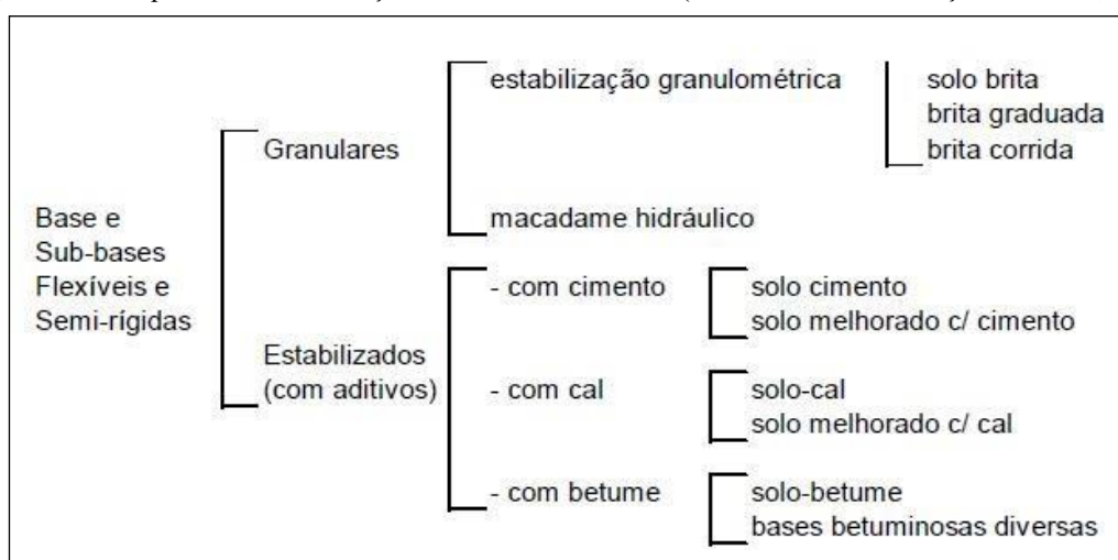
Figura 1.6 – Esquema de classificação das bases e sub-bases (Manual de Pavimentação do DNIT, 2006).
