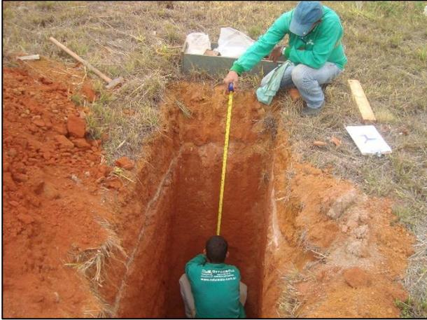
Figura 9. Amostras de solo para execução dos ensaios em laboratório.
