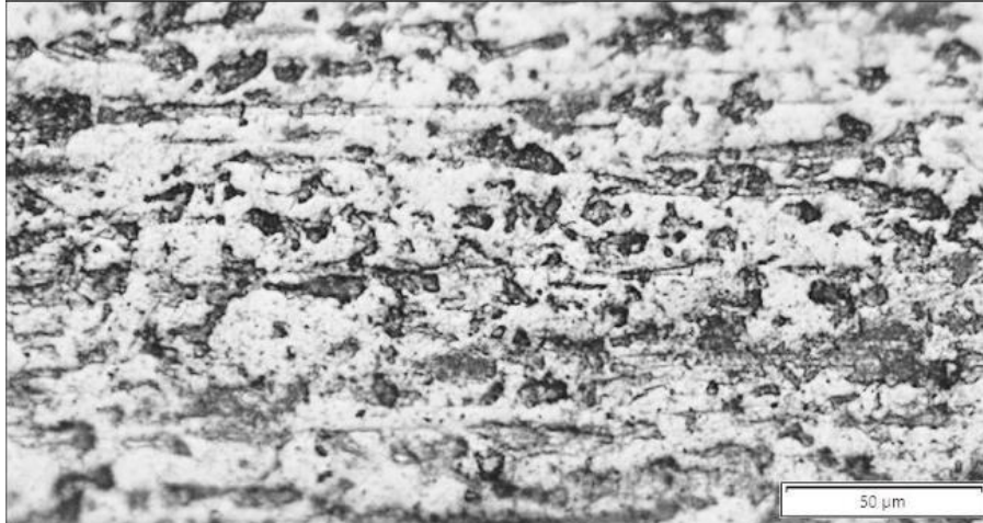
Figura 9 – Micrografia da liga submetida à solubilização e 0,5 h de envelhecimento (aproximação de 20x).
